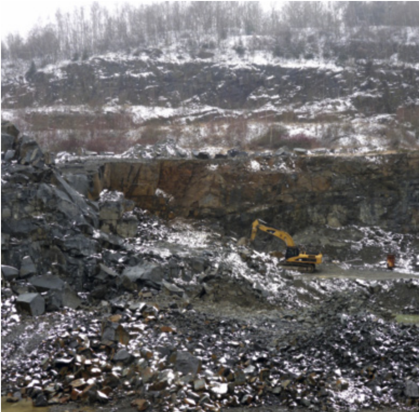
Für den sächsischen SORA LAMPROPHYR-Bruch besteht zunächst bis 2033 Bergrecht. Jährlich werden ihm rund 13.000 t für Wasserbau-, Pflaster- und Mauersteine sowie 600 bis 900 t für Sägeware entnommen. Fotos: Harald Lachmann
