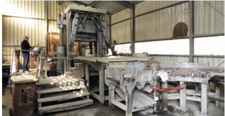
Zur Spaltanlage im Soraer Bruch gehören vier hydraulische Pflasterpressen mit einer Spaltkraft zwischen 50 und 400 t. Dank guter Auftragslage wurde hierfür kürzlich ein weiterer Kollege eingestellt.
