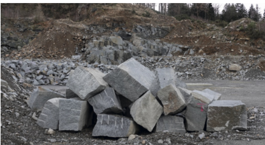
Alle vier bis sechs Wochen wird in Sora eine Wand schonend vom Fels gesprengt. Die Werksteinböcke werden zumeist direkt im Bruch gesägt.
