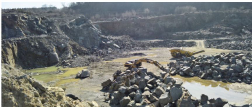
Alle vier bis sechs Wochen sprengt die Firma SKH schonend eine Wand vom Fels. Die Werksteinblöcke werden zumeist direkt im Bruch gesägt. Fotos: Firma
